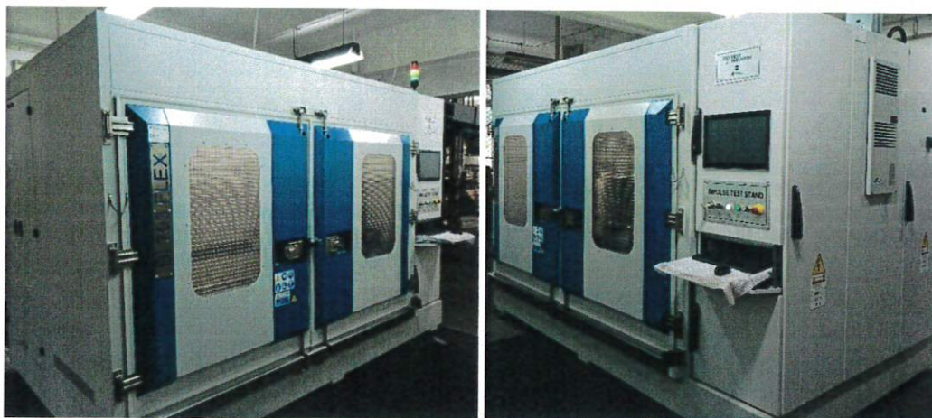
Rys.1 Pulsator E3I 703 FLEX firmy TEST INDUSTRY (data produkcji 2022), znajdujący się w firmie BZPG „STOMIL” S.A. w Bydgoszczy.
