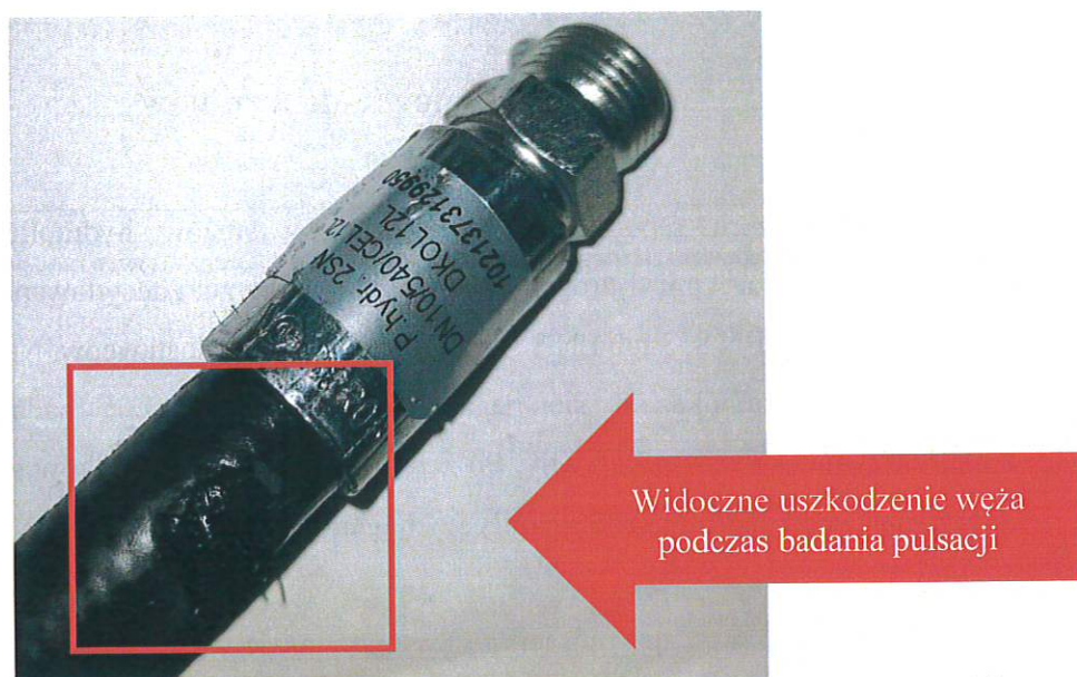
Rys. 22 Przewód dostarczony przez Jelcz po badaniach pulsacji. Wynik negatywny 114 779 cykli.
